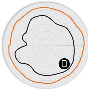
Abbildung 4: R720 2,4 GHz-Elevation-Antennenmuster
